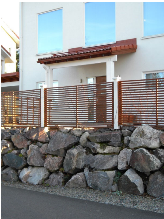
Pihan ja kadun välinen korkeusero on ratkaistu kivimuurilla. (kuva: Arja Sippola, Kirkkonummen Kolsarby)
