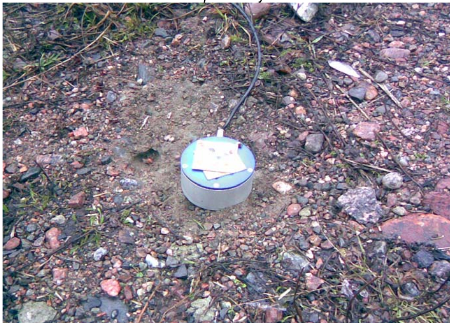
Kuva 1 Kuvassa maahan maapiikillä sijoitettu mittausanturi
