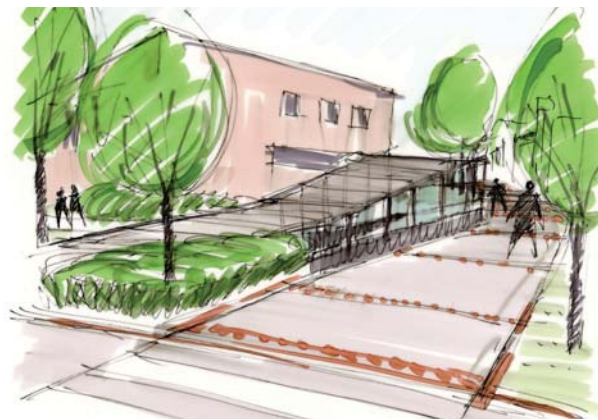
Asematien raitti jatkuu alikäytävänä radan alitse. Luiskaosuus on syytä kattaa läpinäkyvällä katosrakenteella.
